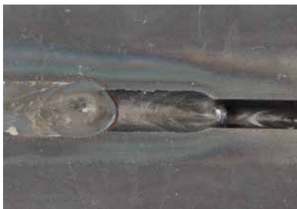
FOCUS.PULS - Lassen in meerdere lagen met kleinere openingshoek. Maximale zekerheid, zie doorsnede afbeelding). Het resultaat telt.
