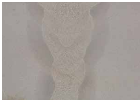
FOCUS.PULS - Lassen in meerdere lagen met kleinere openingshoek. Maximale zekerheid, zie doorsnede afbeelding). Het resultaat telt.
